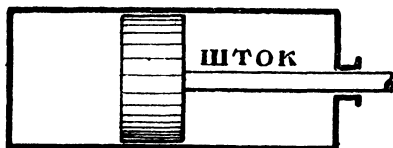
Черт. 4. К зад. № 28. Цилиндр паровой машины.
